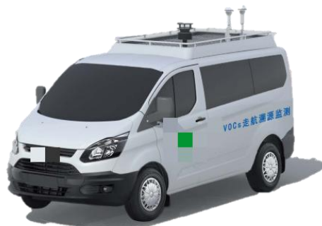
VOCs 走航监测车示意图
